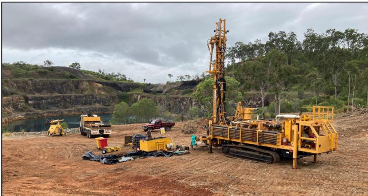
*Abbildung 3: DDH1 Vielzweck-Bohrmaschine UDR 650 vor Ort im Kupferprojekt Mt Chalmers.*
